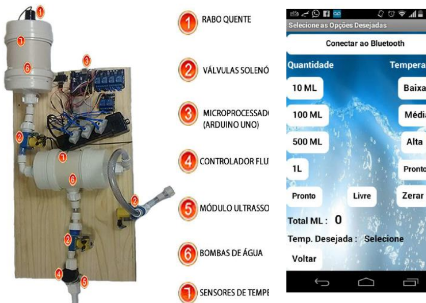
Figura 2 - Foto do projeto Misturador Automático e de Controle de Escoamento de Água.
