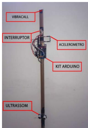
Figura 1 - Foto do projeto bengala eletrônica para cegos.
