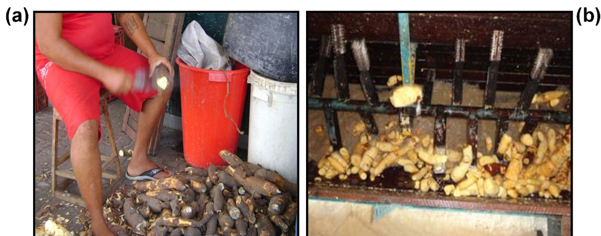
Figura 1. Descascamento manual (a) e mecânico (b) das raízes de mandioca.
