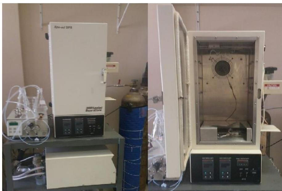
**Figura 7:** Unidade de extração supercrítica (Applied Separations)
