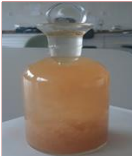
Figura 3 – Floculação na amostra causada pela adição dos reagentes R 1 e R 2 .
