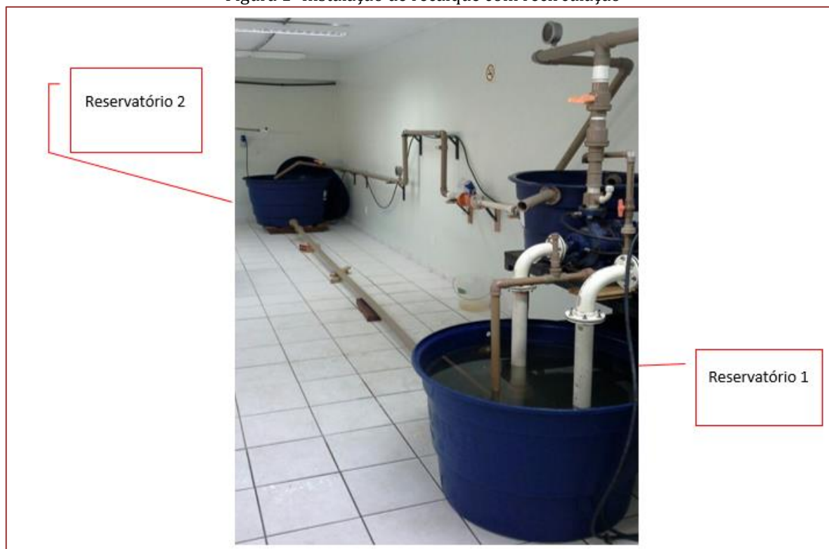
Figura 1- Instalação de recalque com recirculação
