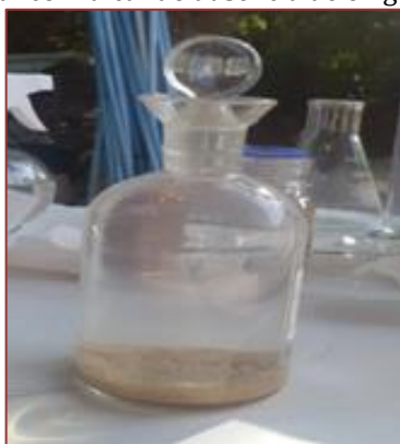
Figura 6 – Precipitado branco indicando ausência de oxigênio na amostra de água
