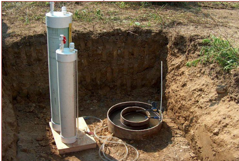
Figura 2 – Ensaio de infiltração com anéis concêntricos sendo realizado a um metro de profundidade da superfície do solo.
