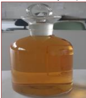
Figura 5 – Presença da coloração amarelada indica a presença de oxigênio na amostra de água
