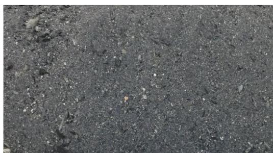
**Figura 1.** Resíduo proveniente da extração do silício metálico testado como adsorvente
