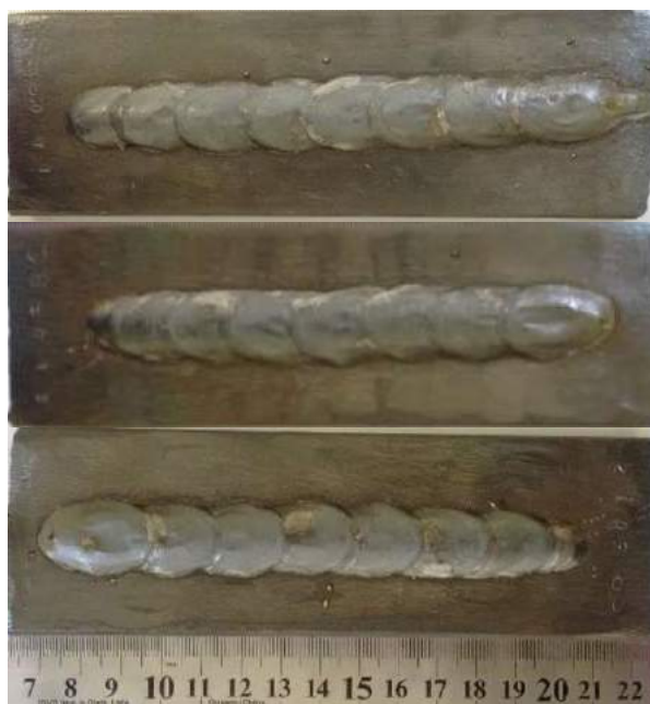
Figura 34. Testes na soldagem de aço baixa liga com switchback na condição GMAW SB50.1.
