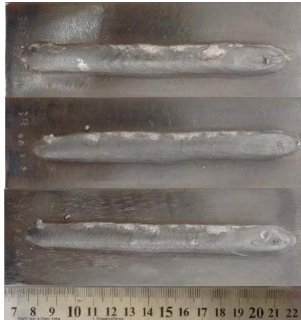
Figura 35. Testes na soldagem de aço baixa liga com switchback na condição GMAW SB90.3.
