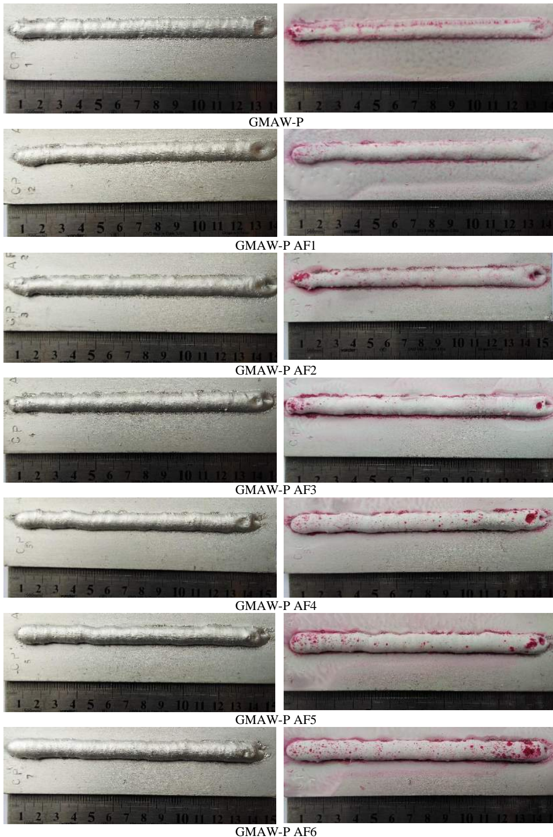
Figura 55. Aspecto superficial e LP das soldas GMAW-P e GMAW-P AF1 a AF6
