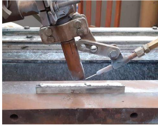
Figura 25. Disposição da tocha de soldagem e do metal de base para deposição de paredes. O dispositivo auxiliar de alimentação somente foi utilizado nas soldas com adição de arame frio.
