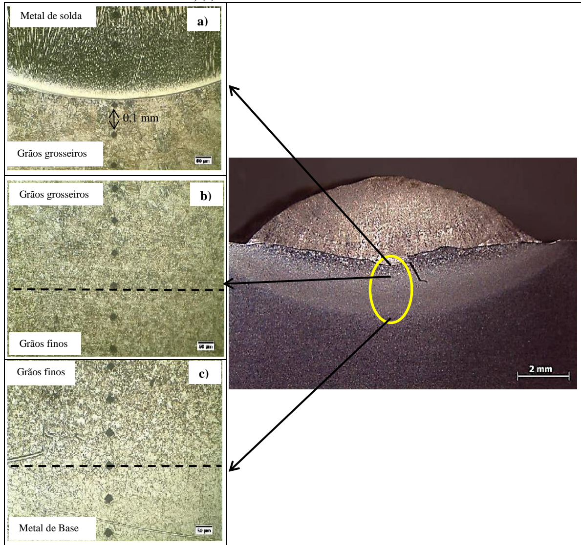
Figura 4.27 - Microestrutura dos grãos MIG P, V_{eq} = 30 cm/min amostra 1P: (a) Linha de fusão; (b) meio da ZTA; (c) Final da ZTA e início do metal de base.
