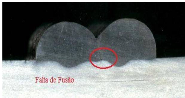
Figura 2.32 - Macrografia revela falta de fusão entre passes.
