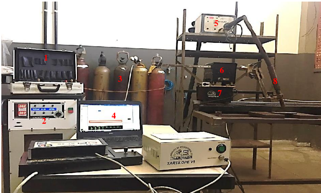
Figura 3.1 - Bancada de trabalho para a realização da soldagem MIG P e MIG PSB
