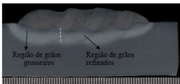
Figura 5.15 - O efeito do ciclo térmico de soldagem sobre os cordões laterais na camada única com aporte térmico 828 J/mm, condição C1. Ataque Nital 10%
