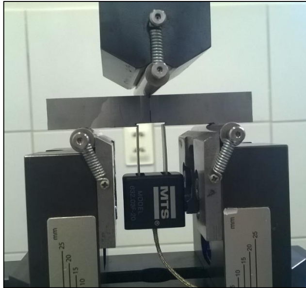
Figura 3.18 - Montagem do corpo de prova no equipamento para realização de ensaio de fratura
