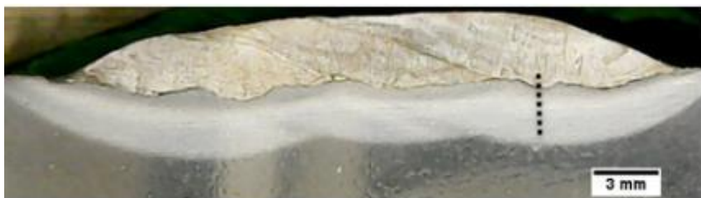
Figura 4.1 - Macrografia da seção transversal da camada de revestimento com o material de enchimento Hastelloy C-276 sobre o aço ASTM A182 F22. Ataque Nital 10%
