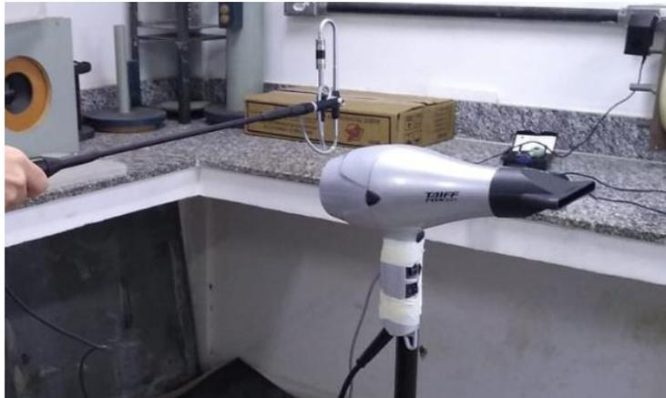
Com a potência sonora do secador determinada, o modelo do ambiente no Odeon foi calibrado de forma que o modelo fornecesse o mesmo campo acústico que os medidos com o decibelímetro. De posse do modelo e as fontes sonoras calibradas, várias simulações de disposição de material absorvente acústico foram realizadas para se chegar na melhor solução para o condicionamento acústico do ambiente.
