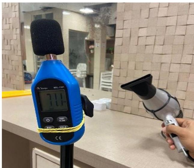
As medições foram realizadas em um dia de segunda-feira, quando o instituto não está aberto ao público. O secador de cabelo, medidor de NPS e silenciador possuem as seguintes especificações: Secador de cabelo com 02 velocidades, Marca TAIFF, Modelo Fox ION 220-230 V 1830-2000 W 50-60 HZ, Decibelímetro Digital MSL 1301 MINIPA calibrado e o redutor de ruído Zhorn para secador de cabelo.
