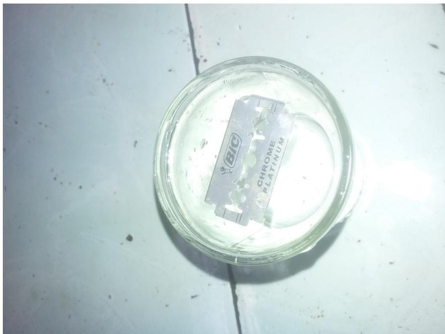
**Figura 5.0-** Ilustração da tensão superficial usando uma gilete. **Fonte:** Arquivo próprio.
