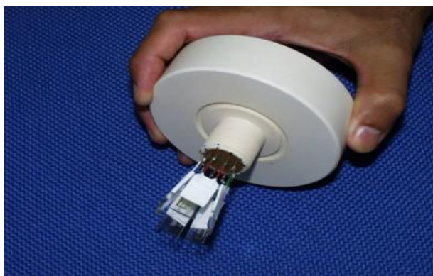
Figura 18 - Língua eletrônica desenvolvida pela EMBRAPA [41]
