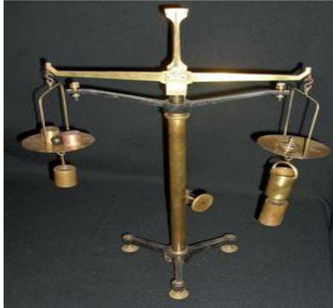
**Figura 1.5:** Balança Hidrostática [25]
