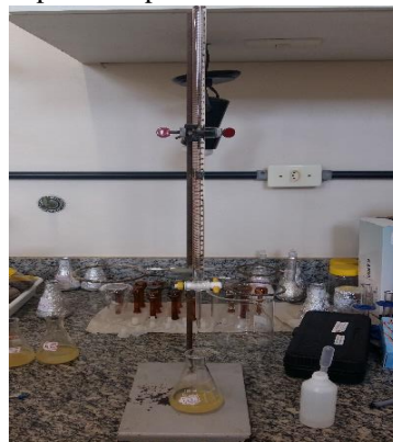
Figura 16. Aparato experimental utilizado na titulação.
