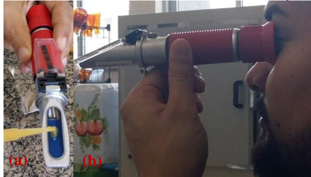
Figura 13. Introdução da amostra no refratômetro (a) e medição de SST (b)
