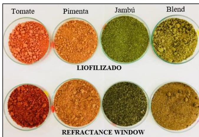
**Figura 10.** Imagens dos pós de tomate, pimenta, jambu e *blend*, obtidos por liofilização e *refractance window*. **Fonte.** Autor.
