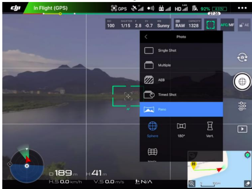
Figura 2 - Tela de Controle de Voo do aplicativo DJI GO 4, com destaque para a configuração do modo de registro das imagens
